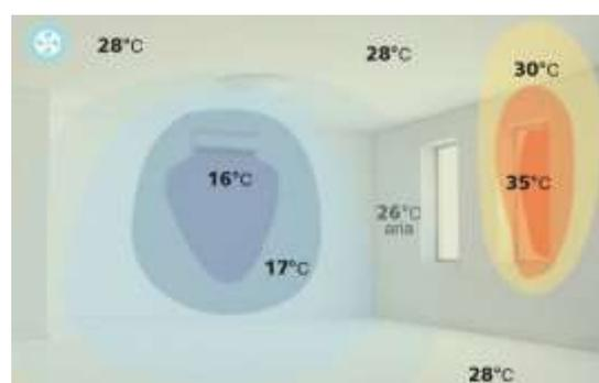
Le immagini descrivono, in maniera puramente indicativa, come il radiante a soffitto in raffreddamento, a differenza degli split tradizionali, trasmetta uniformemente il freddo in estate creando una zona di comfort omogenea.
