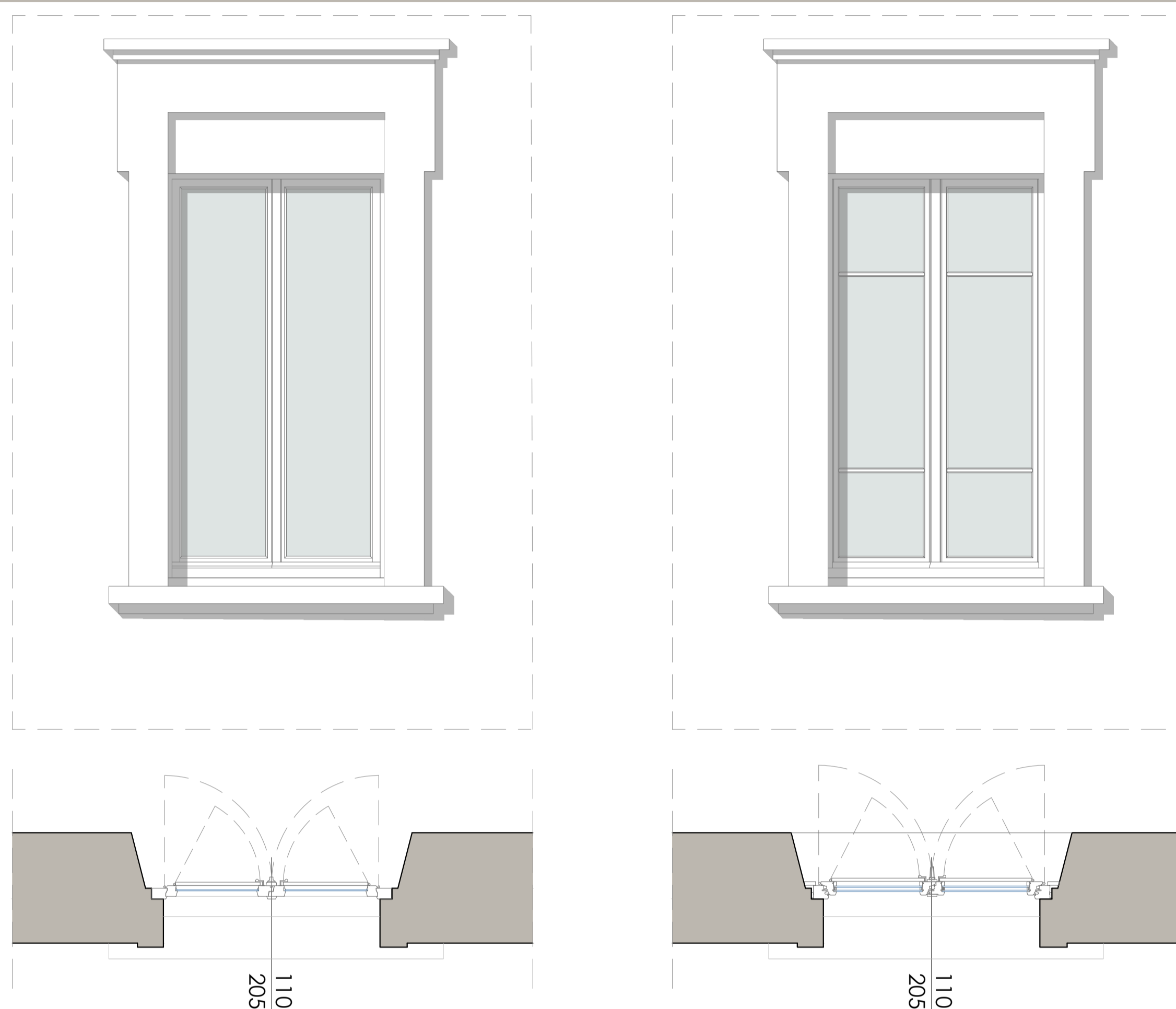
FINESTRA TIPO A stato di fatto - scala 1:20
