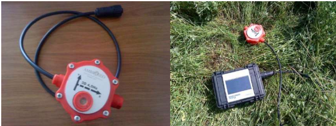
da sx a dx sensore del tromografo Echo 3 e configurazione completa sul campo
