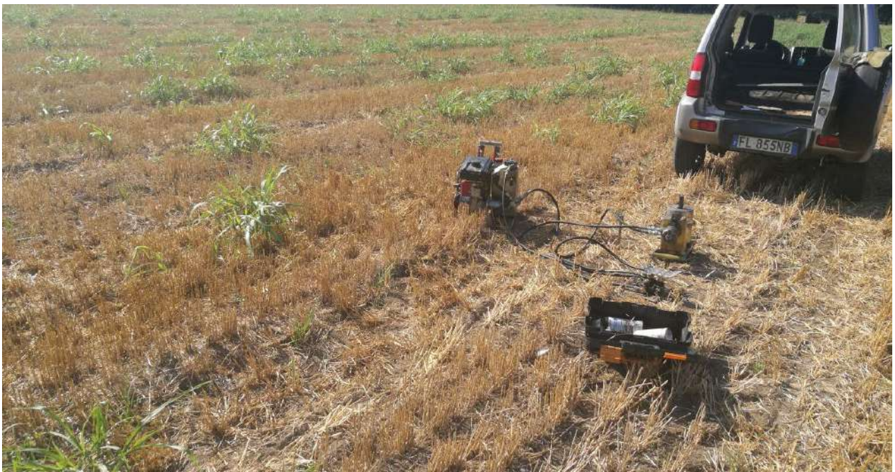
Fasi esecutive delle prove penetrometriche
