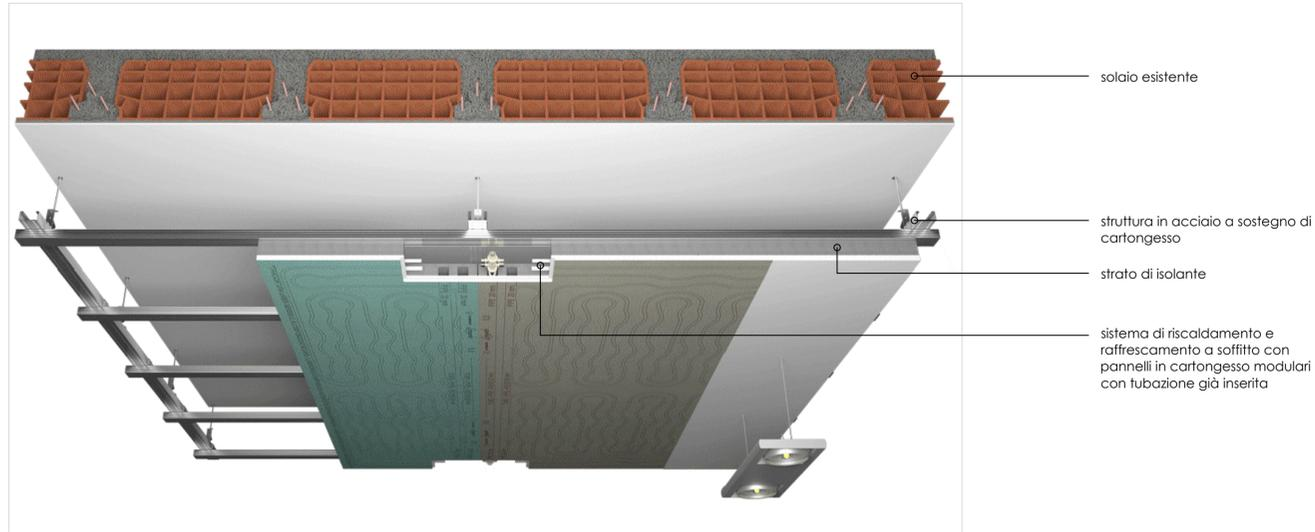
ambienti del piano terra e primo interessati da nuovo impianto di riscaldamento e raffreddamento a soffitto
